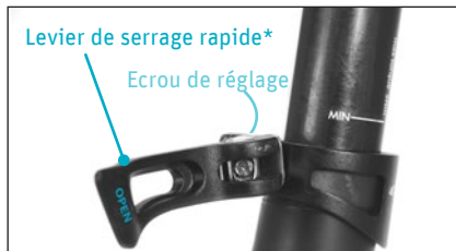
cf. 1. Ouvrir le levier de serrage rapide
