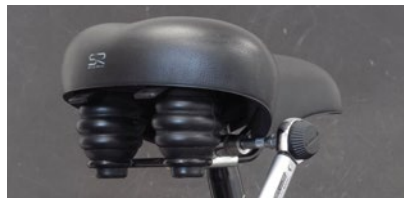
cf. 1. Dévisser l'écrou de serrage
