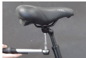
cf. 1. Dévisser la vis de serrage
