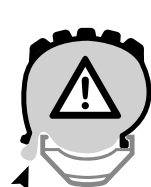
Afbeelding 27. Binnenband gekneld tussen band en velg.
