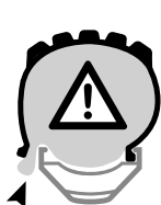
Figura 27. Camera d'aria pizzicata tra pneumatico e cerchio
