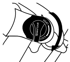
Afbeelding 20. Hendel in de vergrendelde stand
