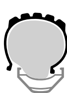
Figura 29. Camera d'aria all'interno del cerchio
